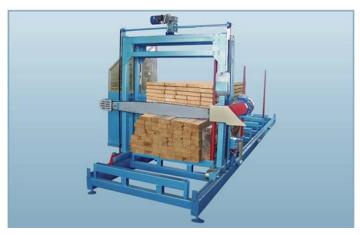
Станок предназначен для торцовки штабелей (пакетов) досок и резки их на определенный размер по длине. Также может быть использован для резки полиэтиленовых труб, бумаги, а также некоторых каменных материалов, например пенобетона, при установке специальных пильных цепей.
