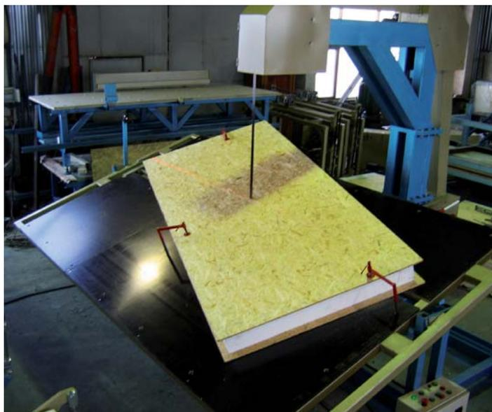
Станок предназначен для раскроя SIP-панелей на любые элементы в соответствии с проектом дома. Принцип работы: панель позиционируется на столе станка по упорам при продольной и поперечной распиловке или по лазерному указателю (при распиловке под углом) и фиксируется съемными прижимами. Ленточнопильный станок, перемещаясь по высокоточным (холоднокалиброванным) направляющим, производит резку панели или нескольких панелей одновременно.
