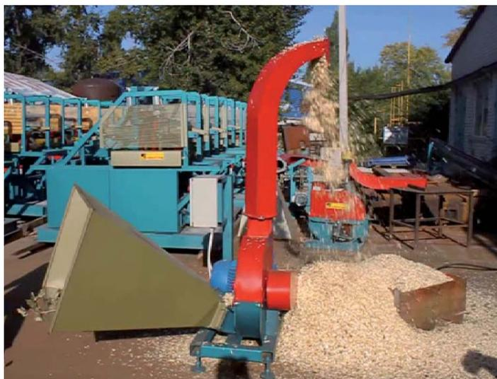
Рубительная машина «АВАНГАРД-МР-500» предназначена для измельчения крупных древесных отходов в технологическую щепу фиксированной длины. Рубительная машина имеет привод от электродвигателя через клиноременную передачу, бункер ручной подачи. Максимальный диаметр обрабатываемого материала - 160 мм.
