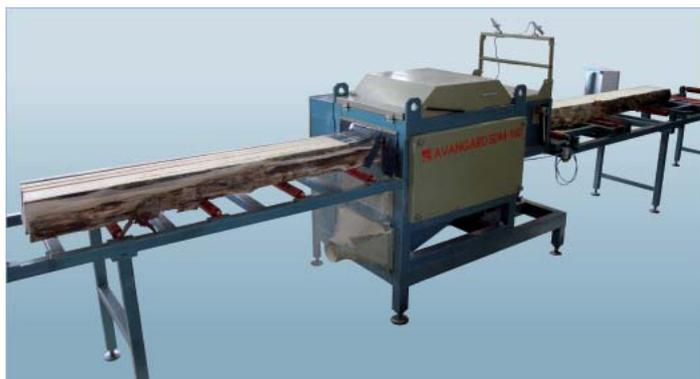
Дисковый многопильный станок «АВАНГАРД-МД-16» предназначен для распиловки двухкантного бруса шириной до 550 мм из любых, в том числе твёрдолиственных, пород древесины на доски при помощи дисковых пил, соответствующих различным породам древесины. Распиловка производится в вертикальной
