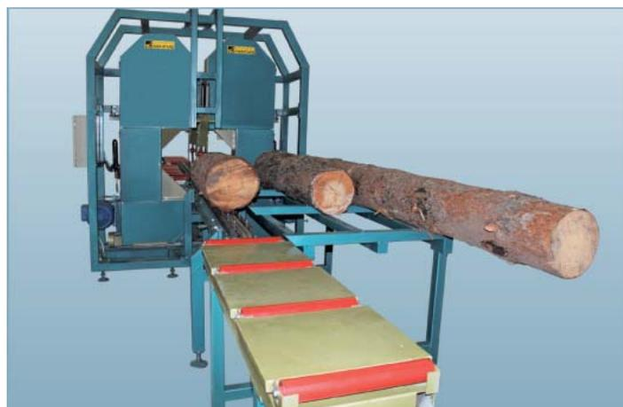
Станки ленточнопильные брусующие серии «АВАНГАРД-ЛП-80-2Б» предназначены для распиловки брёвен диаметром до 450 мм из любых, в том числе твёрдолиственных, пород древесины на 2- и 4-кантный брус при помощи ленточных пил, соответствующих различным породам и диаметрам древесины. Распиловка производится в вертикальной плоскости
