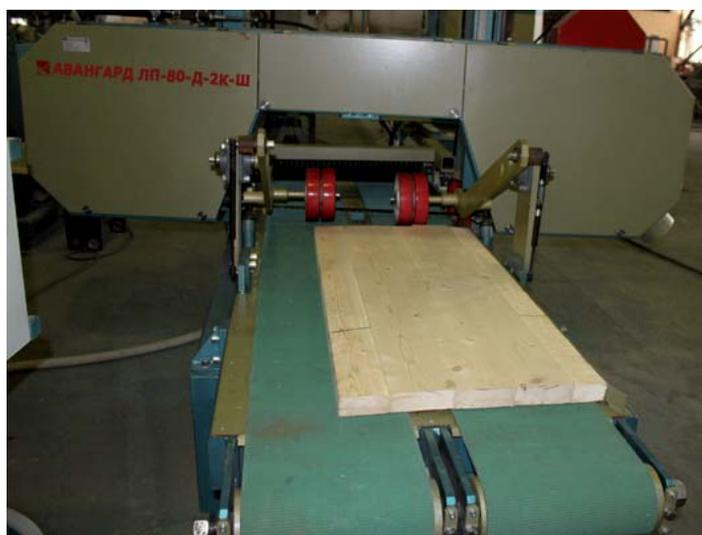
Пилорама «АВАНГАРД-ЛП-80-2Д-2К» оснащена двумя пильными головками, установленными на подрамнике с двумя подающими конвейерами, позволяющими перерабатывать одновременно два горбыля. Станок целесообразно использовать в составе линии по распиловке длинномерной древесины.
