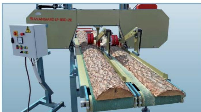
«АВАНГАРД-ЛП-80-Д-2К» - одноголовочный станок, предназначенный для переработки горбыля и деления по толщине досок и брусьев, подаваемых по двум конвейерам. Для проведения нескольких циклов деления станок может быть оснащен возвратным конвейером.
