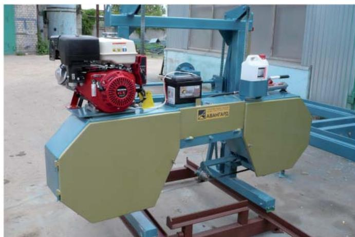
Ленточные пилорамы «АВАНГАРД-ЛП-80» могут поставляться в комплекте со стандартными или с унифицированными механизированными направляющими. Технические данные пилорам позволяют производить радиальное и тангенциальное пиление.
