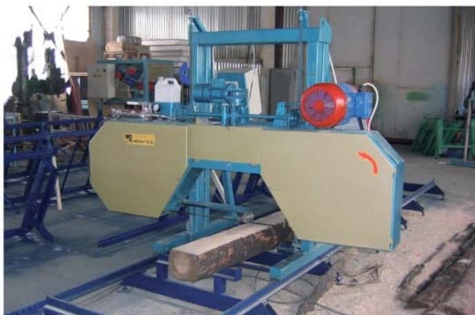
Ленточная пилорама «АВАНГАРД-ЛП-80» предназначена для распиловки брёвен диаметром до 850 мм из любых, в том числе твёрдых пород древесины на брус, доску обрезную, полуобрезную и необрезную, а также рейку при помощи ленточных пил, соответствующих различным породам и диаметрам древесины. Распиловка производится
