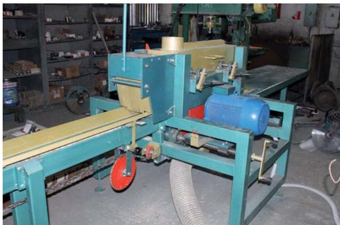
Входная часть подающего конвейера станка «Авангард-СДБ-180» имеет откидные направляющие, что позволяет дополнительно пропускать ранее опиленый двухкантный брус с целью получения четырехкантного бруса.
