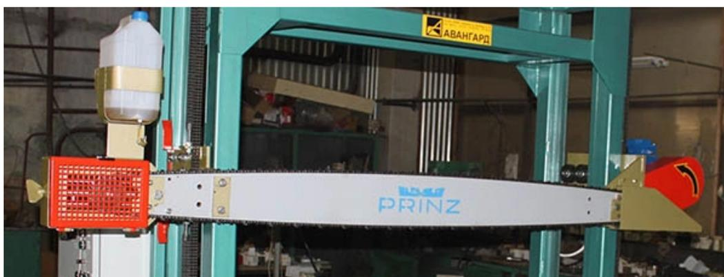
Шина «PRINZ» имеет большую ширину и оснащена независимой ведомой звездочкой, которой производится натяжение цепи. Длина цепи 4580 мм.
