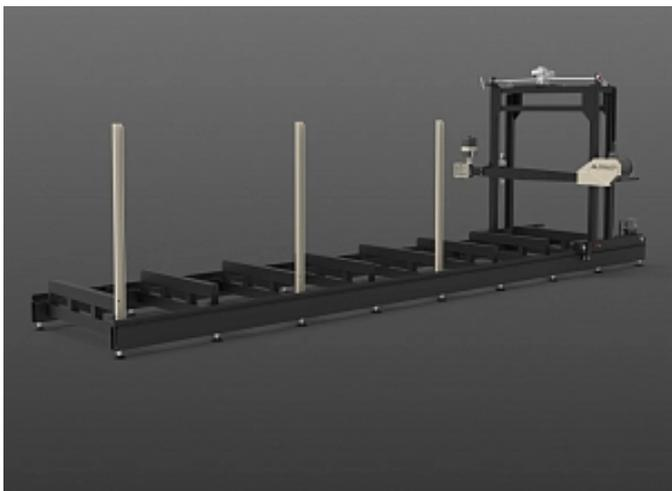
Станок предназначен для торцовки штабелей (пакетов) досок и резки их на определенный размер по длине. Также может быть использован для резки полиэтиленовых труб, бумаги, а также некоторых каменных материалов, например пенобетона, при установке специальных пильных цепей. Отрезка производится при вертикальном перемещении шины с пильной цепью. Двухопорная система крепления шины обеспечивает высокую точность и качество среза.
