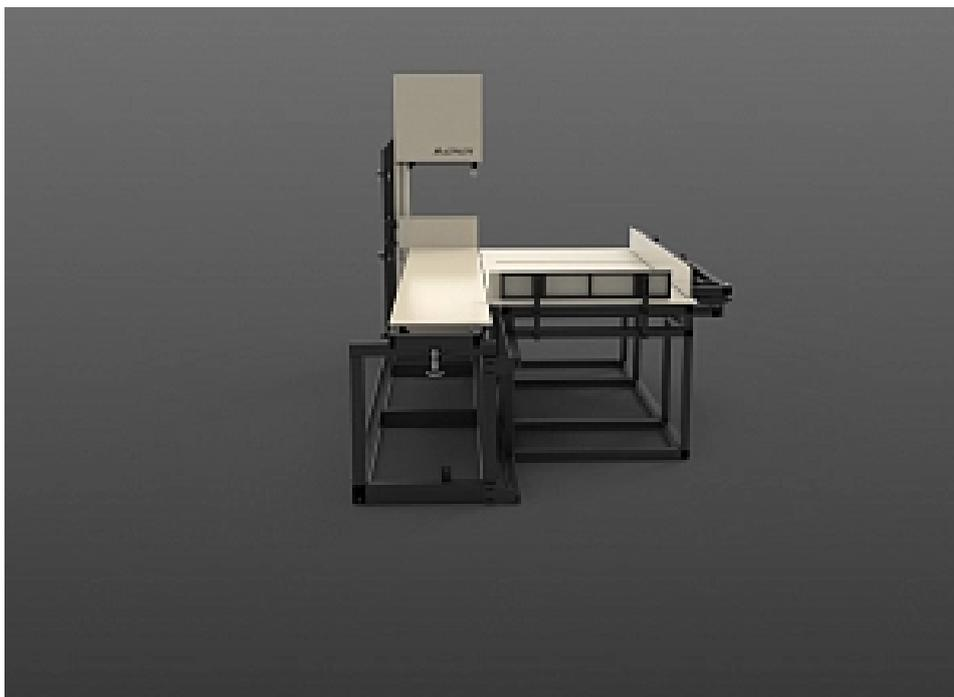
Станок предназначен для распиловки пакета минерало-ватных плит на ламели . Принцип работы: Пакет минерало-ватных плит укладывается на автоматизированный подающий стол. Подача пакета плит в зону резки осуществляется программируемым толкателем. Распиловка производится перемещением вертикального ленточнопильного узла по калиброванным направляющим. Отделенные от пакета ламели остаются на неподвижном столе станка, откуда обратным ходом пильного узла удаляются из зоны резки.
