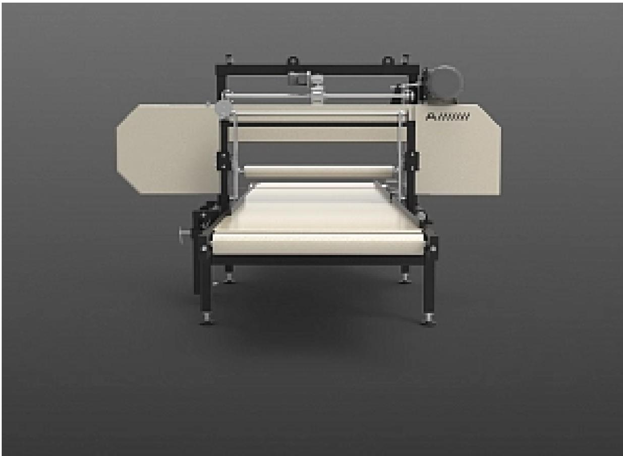
Станок предназначен для деления по толщине различных материалов, в том числе смонтированных на общем подрамнике с подающим ленточным конвейером, оснащенный прижимами минераловатных плит. Станок включает в себя 2 горизонтальных ленточнопильных узла.
