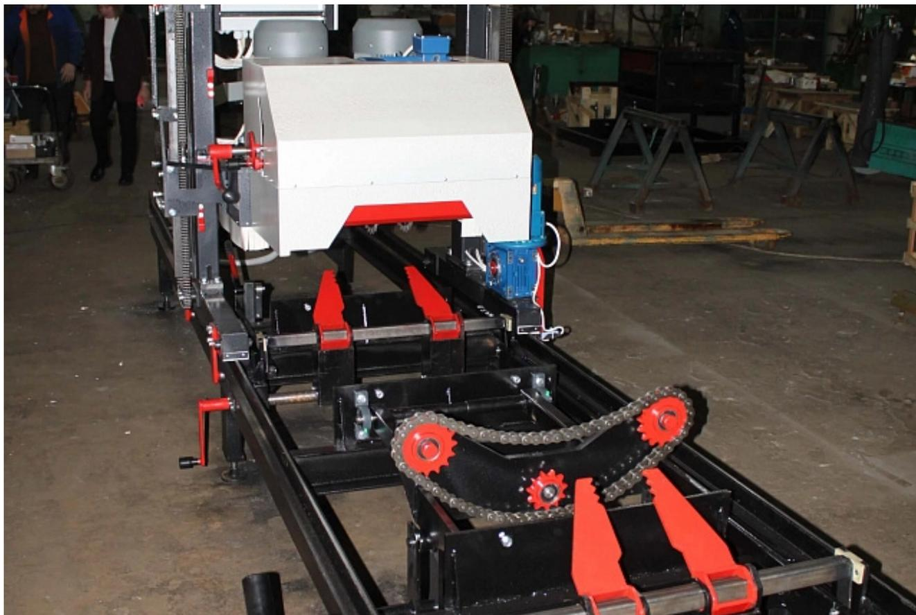
Пилорама предназначена для распиловки дисковыми пилами круглого сырья диаметром от 100 до 320 мм (распиловка больших диаметров производится с дополнительной промежуточной кантовкой бревна, с условием обеспечения ширины пропила 300 мм). Длина сырья до 6,2 м.
